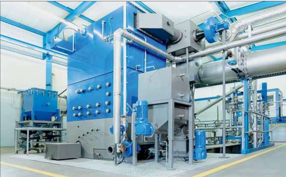
Unterschub-Feuerungsanlage für die gestufte Verbrennung von Holz-Reststoffen im Technikum von Fraunhofer Umsicht. Foto/Grafik: Fraunhofer Umsicht
